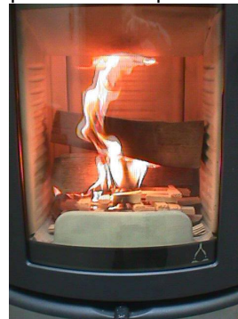
III. 3 : Chiusura presa dell'aria primaria
