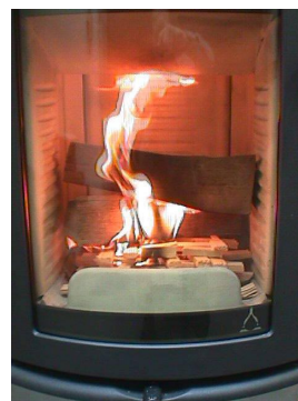
III. 3 : Chiusura presa dell'aria primaria
