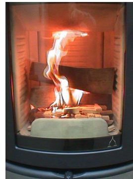
III. 3 : Chiusura presa dell'aria primaria
